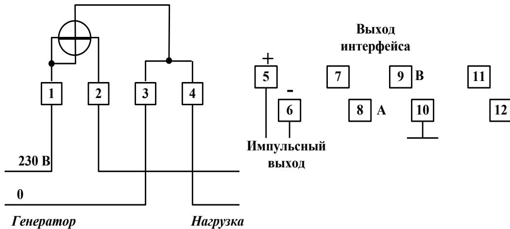
Примечание - Предельное напряжение, подаваемое на импульсный выход - 24 В, предельный ток - 30 мА.
