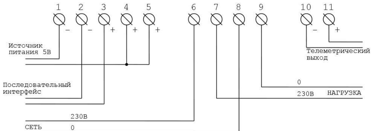
**Примечание:** Номинальное напряжение, подаваемое на телеметрический выход (конт. 10 и 11), равно 12 В (пределное - 24 В). Номинальная сила тока этого выхода - 10 мА (пределная - 30 мА).
