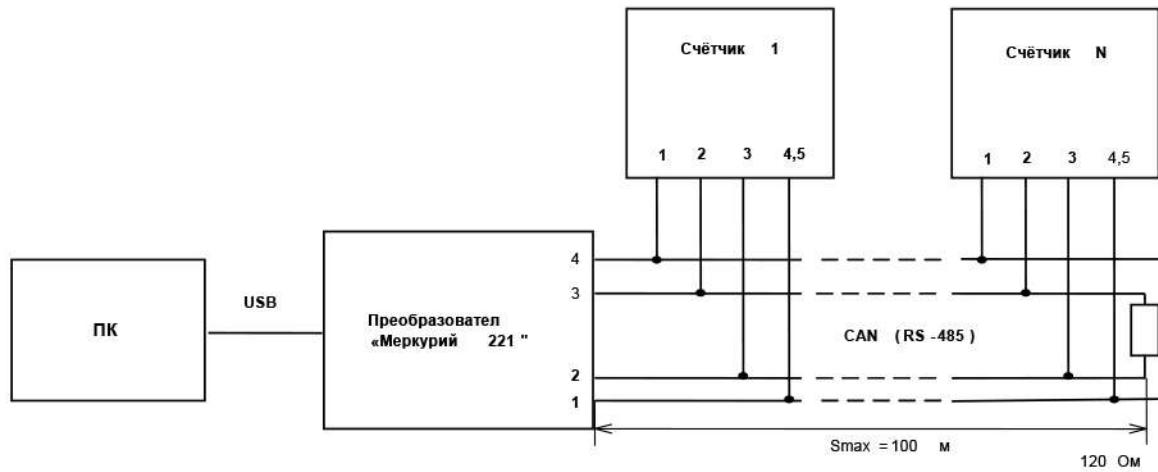
**Примечание:** Схема используется для счётчиков с внешним питанием от преобразователя.
