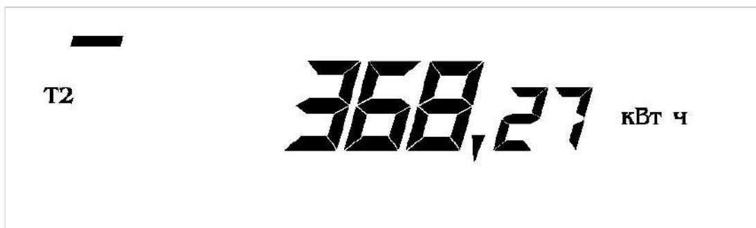
При нажатии на клавишу «**ВВОД**» циклически изменяется номер тарифа, по которому индицируется величина накопленной энергии. После последнего тарифа (если счётчик четырехтарифный, то после четвёртого, если трехтарифный - после третьего, если двухтарифный - после второго) индицируется сумма накопленной энергии по всем действующим тарифам, при этом слева индицируется номер, показываемого тарифа, а если индицируется сумма, то в нижней части появляется надпись «**Сумма**».
