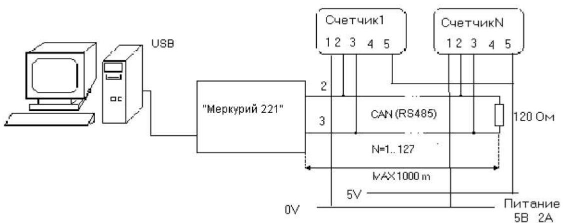
**Примечание:** Схема используется для счётчиков с внешним питанием
