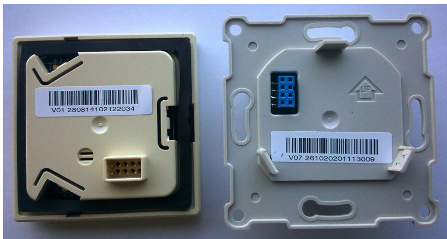
Рис. 1. А. Вид стикеров на корпусе модуля индикации и на модуле питания терморегулятора.
