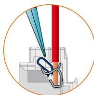
Для извлечения кабеля использовать отвертку
