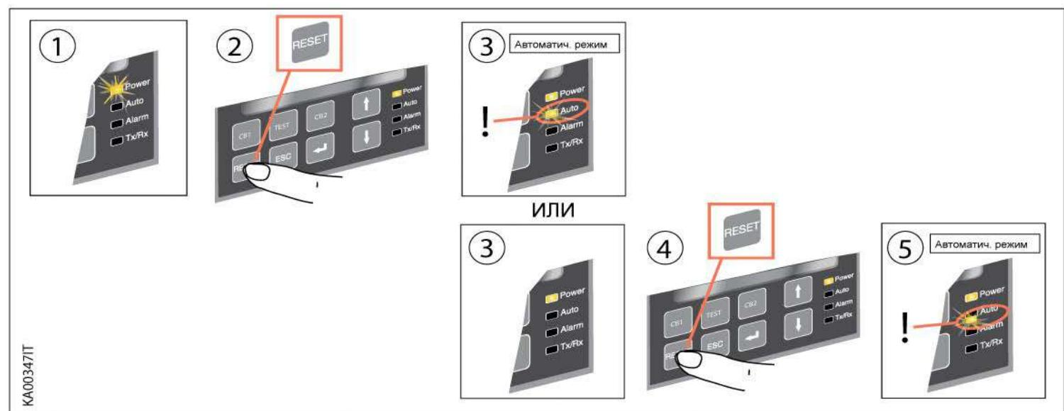
Рисунок 5.3: Описание процедуры выбора Автоматического режима работы ATS022
