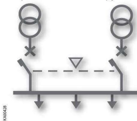
Рисунок 4.1: Схема применения 2CBs (2 Выключателя) – Генератор не используется
