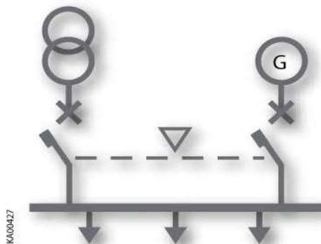
Рисунок 4.3: Схема применения 2CBs (2 Выключателя) – генератор используется
