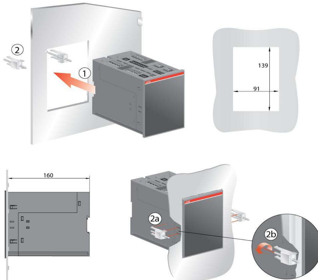
Рисунок 8.1: Установка на дверь ATS022
