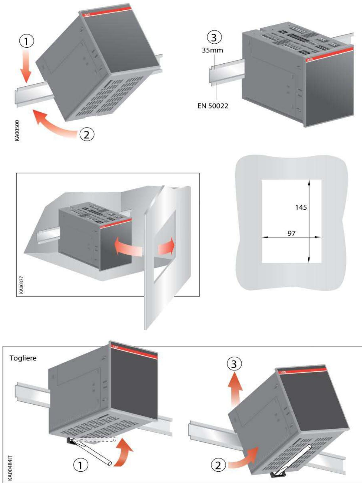
Рисунок 8.2: Рисунок 8.1 : Установка на дин-рейку ATS022
