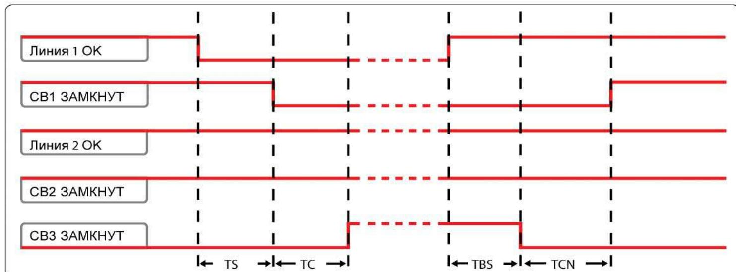
Рисунок 4.12: Временная диаграмма 3CBs BUS TIE (3 Выключателя. 2 ввода и секционный выключ.)
