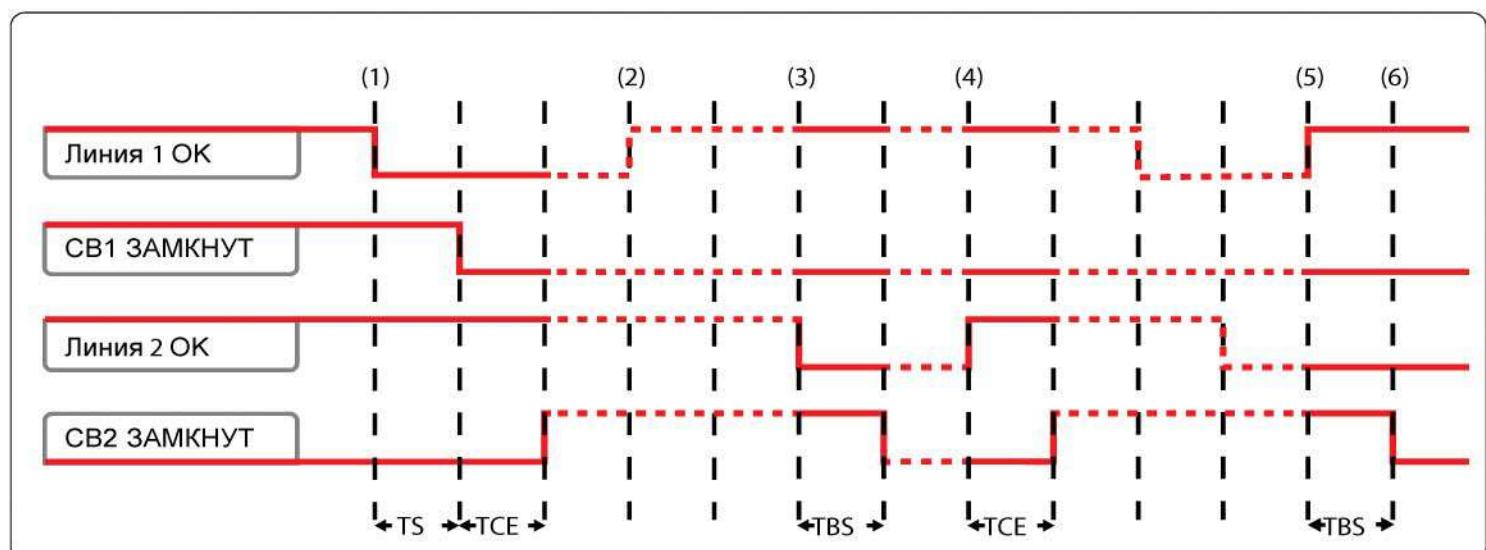
Рисунок 4.14: Временная диаграмма 2CBs (2 выключателя) - генератор не используется – без процедуры автоворота
