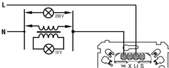
Рис. 2. Подключение к стандартной электрической сети
