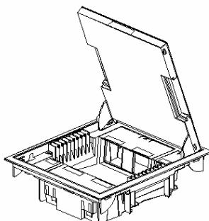
Коробки для установки в технические отверстия глубиной  $\geq 65$  мм
