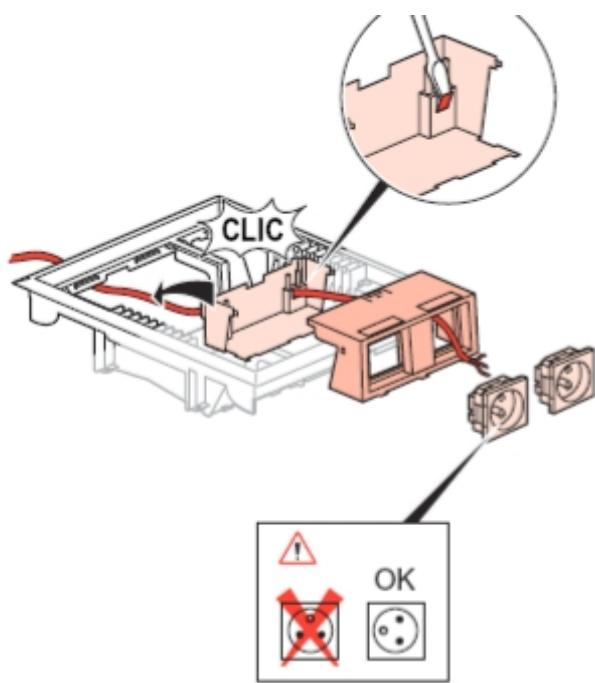
Будьте внимательны при установке розеток в суппорты (в случае, если гнездо заземления будет находиться наверху, вставить угловую вилку будет невозможно)
