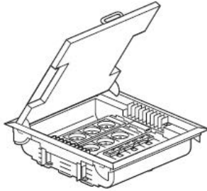
Напольные коробки регулируемой глубины с суппортами
