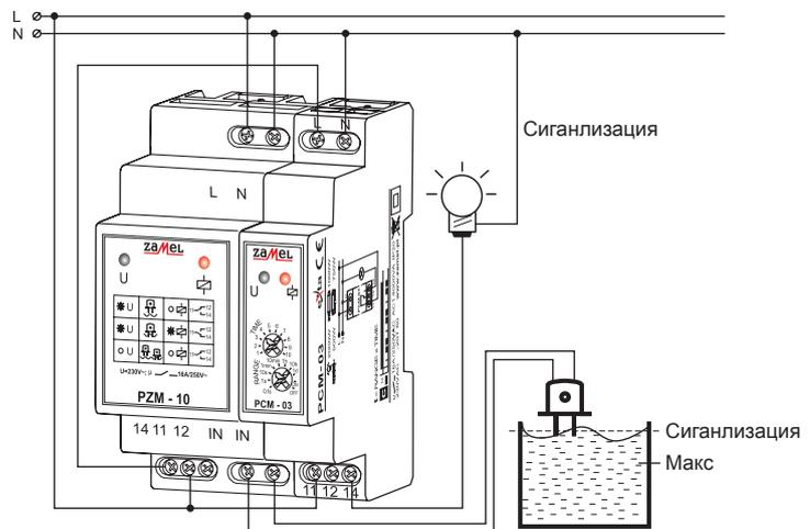
Реле времени РСМ-03 работает в качестве циклического включения питания для сигнализационной системы. Работает с системой реле контроля уровня жидкости PZM-10 включая циклически сигнализационную систему для обнаружения жидкости на уровне установленного датчика.
