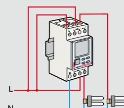
Время замыкания и размыкания выходных контактов вычисляется на основе даты, текущего времени и географических координат места установки
