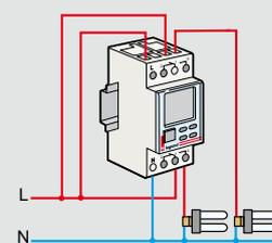
Время замыкания и размыкания выходных контактов вычисляется на основе даты, текущего времени и географических координат места установки
