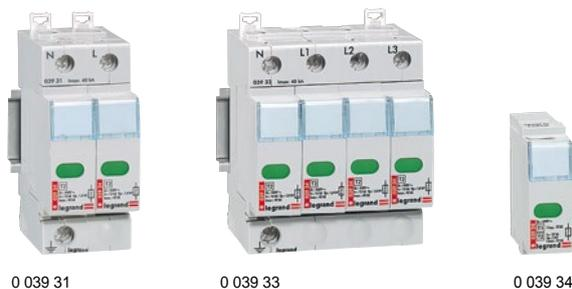
УЗИП Класс 2 предназначены для защиты сети от коммутационных помех или как вторая ступень защиты при ударе молнии. Нормируется импульсным током с формой волны 8 / 20 мкс. Состоят из основания и сменных модулей с сигнальным индикатором:
