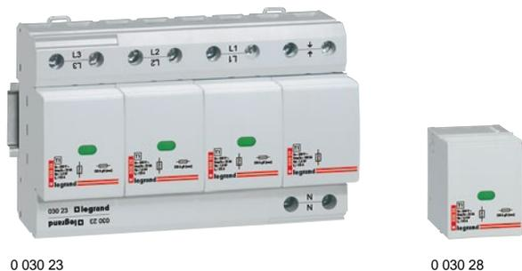
УЗИП Класс 1 Предназначены для защиты от прямых ударов молнии в систему молниезащиты здания или воздушную линию электропередач (ЛЭП). Устанавливаются на вводе в здание во вводно-распределительном устройстве (ВРУ) или главном распределительном щите (ГРЩ). Нормируются импульсным током  $I_{imp}$  с формой волны 10/350 мкс. Соответствуют МЭК 61643-1
