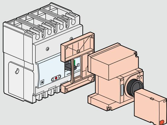
■ **Стандартная поворотная рукоятка для непосредственного монтажа на аппарате**
