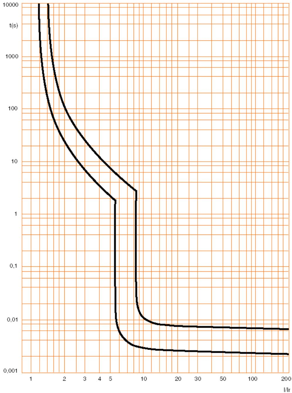
**Модульный автоматический выключатель DX<sup>3</sup> 10000 А / 16 кА, от 80 А до 125 А (1,5 модуля на полюс)**
