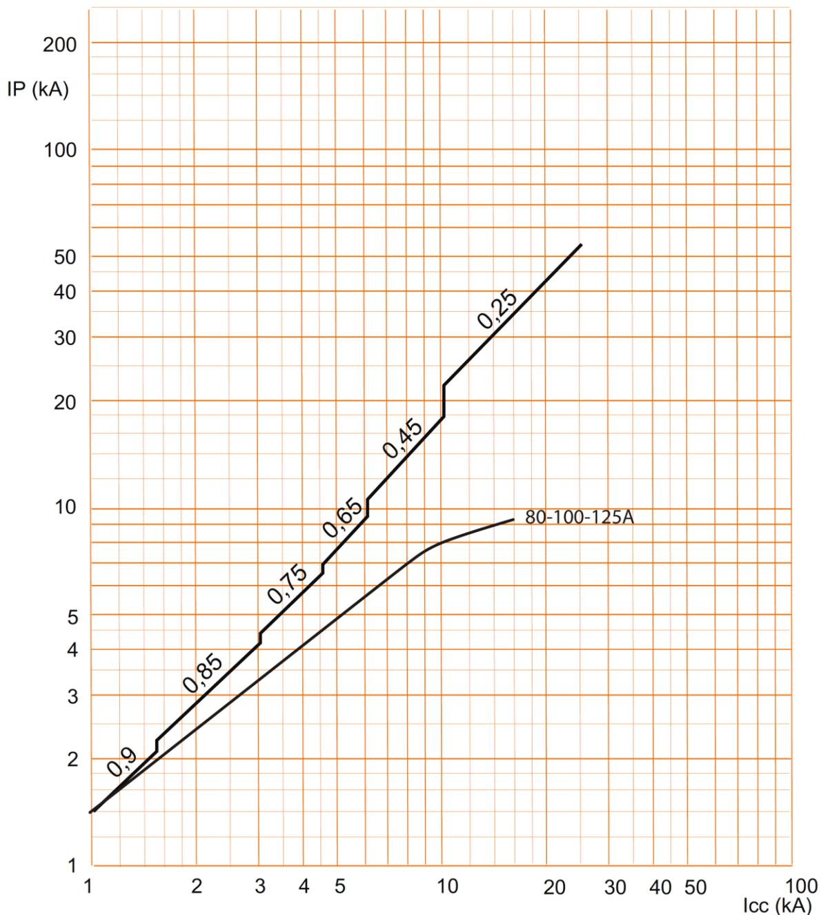
.  $I_{cc}$  = действующее значение расчётного тока симметричного короткого замыкания (кА).
