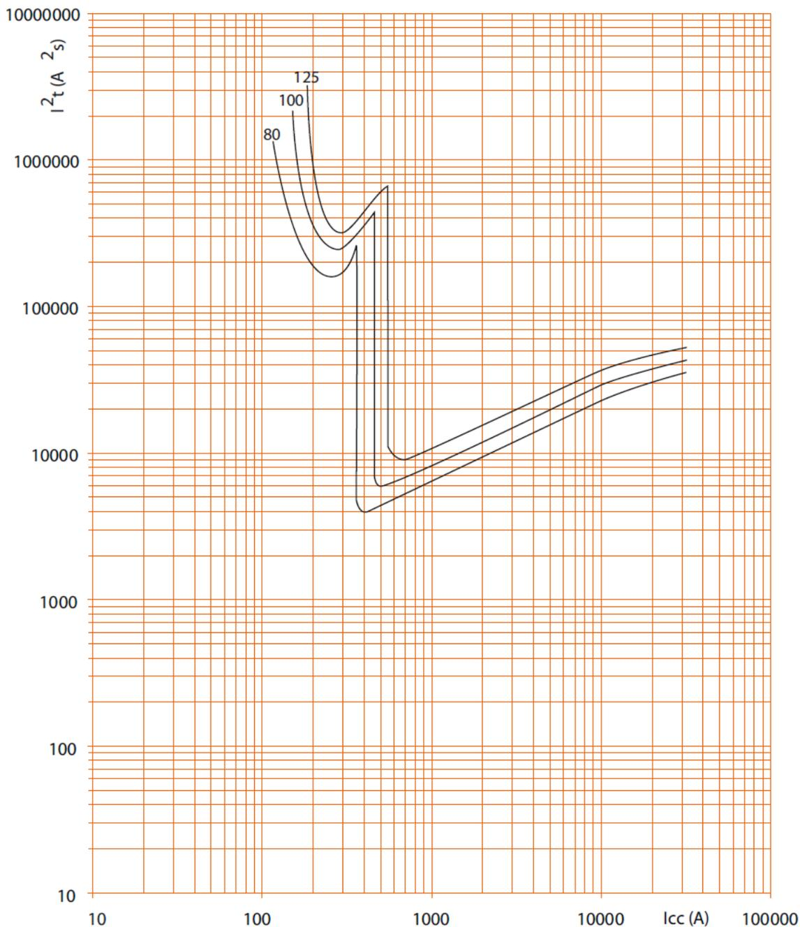
.  $I_{cc}$  = действующее значение расчётного тока симметричного короткого замыкания (кА).
