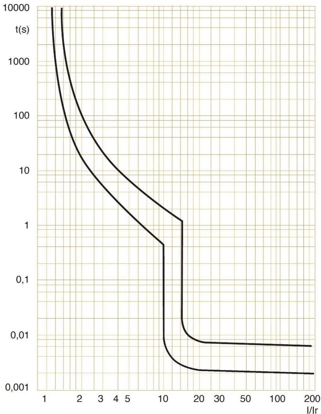
**Модульный автоматический выключатель DX<sup>3</sup> 10000 А / 16 кА, от 80 А до 125 А (1,5 модуля на полюс)**
