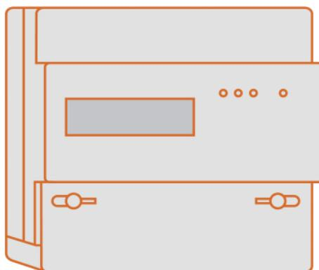
Светодиодный индикатор функционирования, выдающий световые импульсы, пропорциональные количеству потребляемой энергии;
