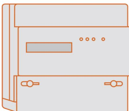
Индикаторы функционирования измерительных элементов каждой из фаз;
