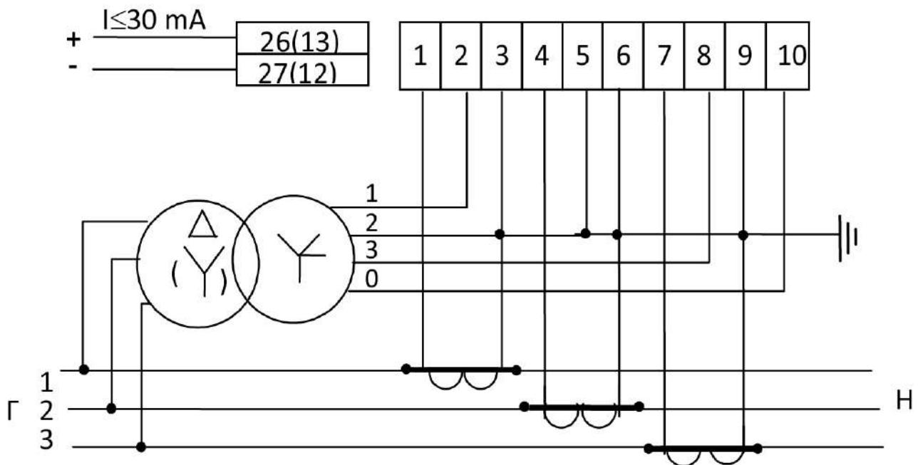
**Примечание** — Номера контактов испытательных выходных устройств (телеметрических выходов) зависят от исполнения корпуса и кожуха и соответствуют схеме подключения счетчиков на крышке зажимов.
