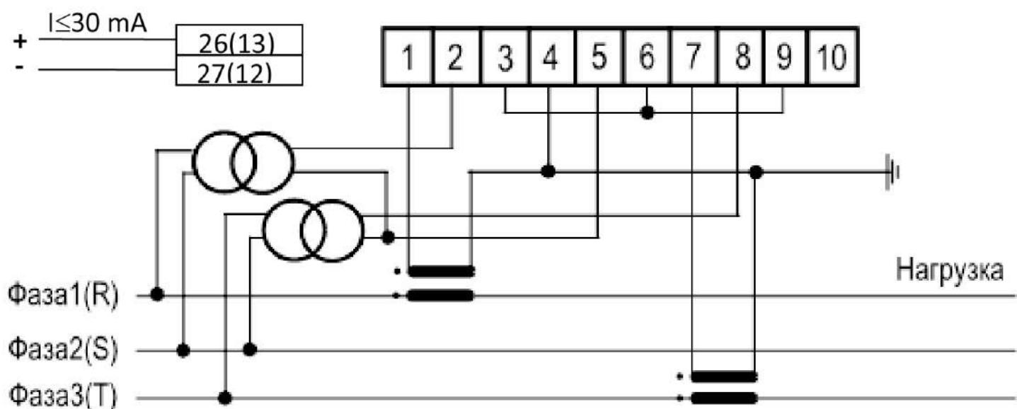
**Внимание!** Заземление цепей напряжения производить согласно схеме подключения трансформатора напряжения на объекте.
