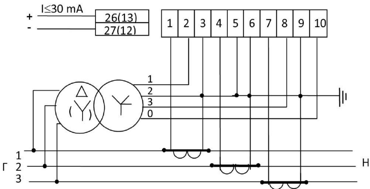
**Примечание** — Номера контактов испытательных выходных устройств (телеметрических выходов) зависят от исполнения корпуса и кожуха и соответствуют схеме подключения счетчиков на крышке зажимов.
