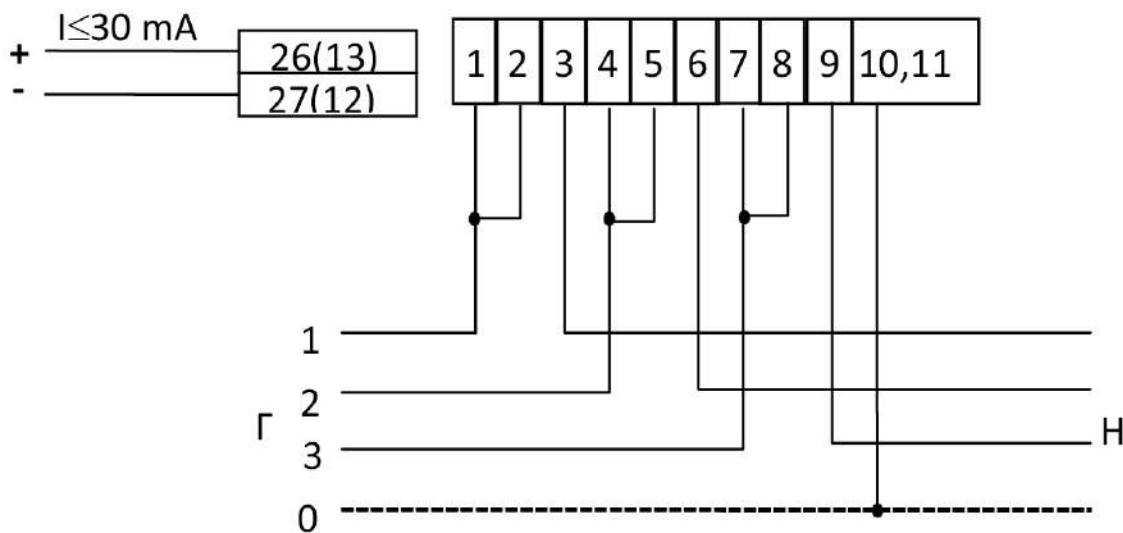
**Примечание** — номера контактов испытательных выходных устройств (телеметрических выходов) зависят от исполнения корпуса и кожуха и соответствуют схеме подключения счетчиков на крышке зажимов.
