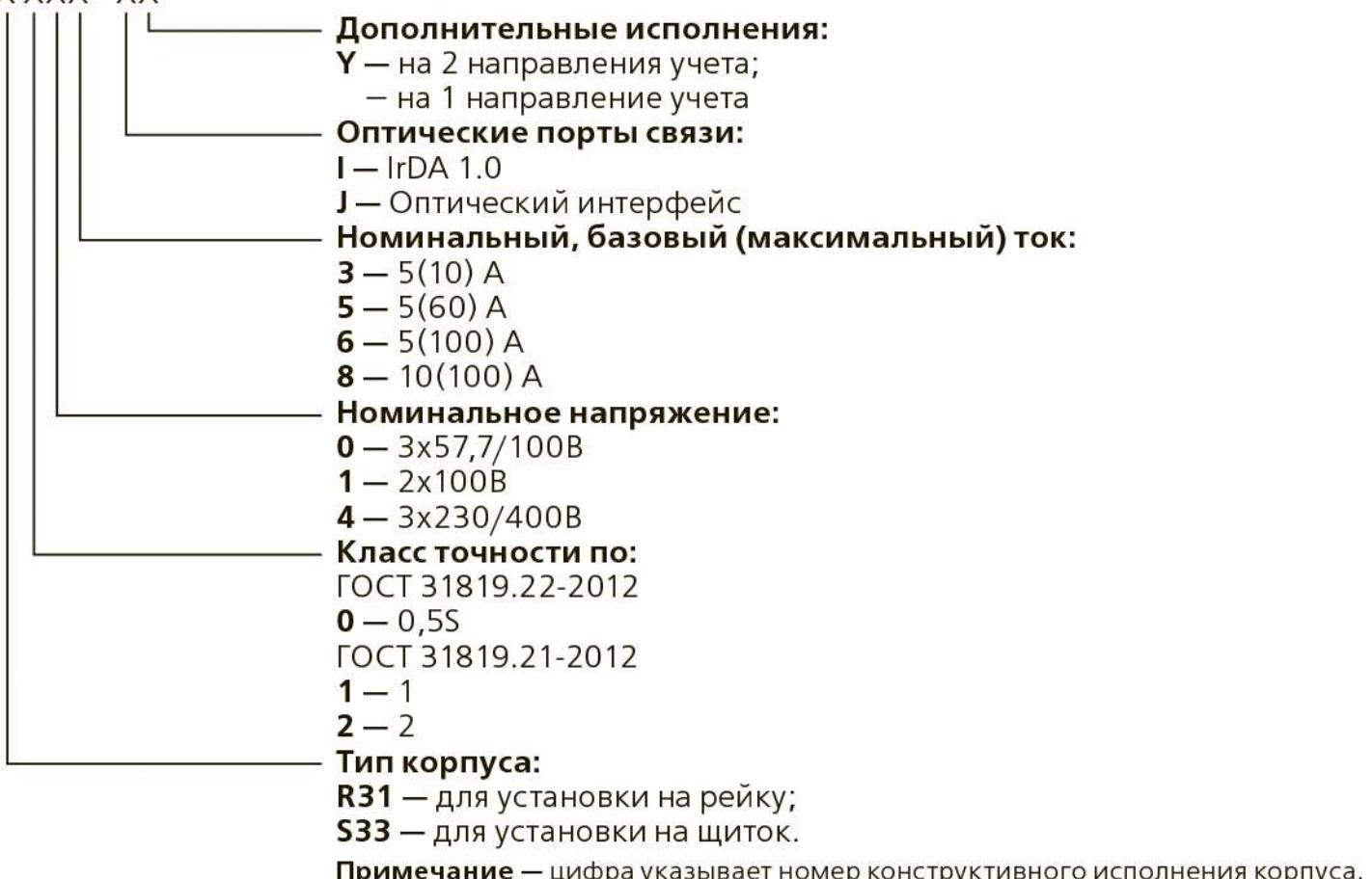
Рисунок 1 – Структура условного обозначения счетчика СЕ300
