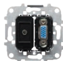
Механизм с комбинированными разъёмами VGA + mini-jack, 3,5 мм С лицевой стороны: 1 разъём VGA (тип: DE-15) и 1 разъём mini-jack (аудиоразъём, 3,5 мм, стерео). С обратной стороны: VGA — винтовые клеммы (15 проводов); mini-jack, 3,5 мм, — винтовые клеммы. Без монтажных лапок. Накладки: арт. 8555.4.
