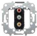
Механизм разъёма 3 x RCA С лицевой стороны: 3 разъёма RCA (красный, белый, жёлтый). С обратной стороны: винтовые клеммы (6 проводов). Без монтажных лапок. Накладки: арт. 8555.3.
