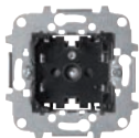
Розетка французского стандарта с заземлением, плоская Номинальное напряжение: 250 В~. Номинальный ток: 16 А. Тип E: 2P + E. С защитными шторками. Безвинтовые клеммы. Включено в комплектацию: монтажные лапки. Накладки: арт. 8587.9.
