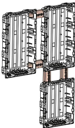
**■ 7.2 Комплект крепежных скоб для гипсокартонных стен, кат. №. 4 017 24**
