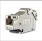
Универсальный модуль, RJ45, кат. 6A iso, экранированный 1) 1 разъем, 8(8) полюсов Для монтажа в монтажном адаптере 0219/12 или 0219/13. Также подходит для монтажа на центральной плате 2561 и в цоколе 1812, 1866 EB и 1867 EB. Подключения RJ-45 для сетей кат. 6A, класса EA (10 Гбит/с / 500 МГц). Соответствует кат. 6A, классу EA согласно ISO/IEC 11801:2011-06. Кат. 6A согласно ISO/IEC 11801: 2011-06. Маркировка подключений А и В согласно TIA/EIA-568-B.2. Модель соответствует EN 60 603-7-51:2011-01. экранирование в соответствии с DIN EN 55022, класс В. Подходит для PoE+ согласно IEEE 802.3at, ≥ 1000 ци-клов вставки. Прокладка кабеля по оптимальному радиусу (30°). Возможно заземление корпуса с помощью 6,3-милли-метрового плоского штекерного соединителя с тыльной стороны. Испытано после повторного монтажа. Подходит для смещения и подгонки. только для 8-полюсного штекера RJ 45 Корпус из цинкового сплава, отлитого под давлением. Встроенный пылезащитный колпачок (по запросу съёмный). Клеммы. Для кабеля для передачи данных, диаметр 6 - 10 мм. Для жил AWG 24-22. Для монтажа в кабельных каналах, монтажных коробках с/у и подпольных системах.
