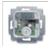
Электронный механизм комнатного терморегулятора 1) 2) 3) С индикатором температуры: ФАКТ. значение Автоматическая калибровка регулятора Переключающий контакт размыкается по достижении заданной температуры. с контрольной лампой и переключателем для экономичного режима (снижение температуры 4К), с крепежными распорками, с отдельным входом для временно-зависимого переключения в экономичный режим, Номинальное напряжение: 24 В~ Номинальный ток: 1 А Температурный режим применения: 5 °С до 30 °С EN 60730-2-9, EN 60669-2-1
