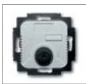
Электронный механизм комнатного терморегулятора 1) 2) 3) с перекидным контактом с крепежными распорками, Номинальное напряжение: 230 В~ Номинальный ток: 5 А Температурный режим применения: 5 °С до 30 °С EN 60730-2-9, EN 60669-2-1
