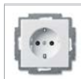
Механизм розетки SCHUKO® 1) с защитными шторками с безвинтовыми клеммами 2 P + E Номинальное напряжение: 250 В перем. тока Номинальный ток: 16 А
