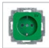
Механизм розетки SCHUKO® с маркировкой с безвинтовыми клеммами 2 P + E цветная маркировка центральной платы и цоколя Номинальное напряжение: 250 В перем. тока Номинальный ток: 16 А
