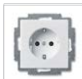
Механизм розетки SCHUKO® 1) с защитными шторками с безвинтовыми клеммами 2 P + E Номинальное напряжение: 250 В перем. тока Номинальный ток: 16 А
