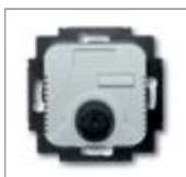
Электронный механизм комнатного терморегулятора 1) 2) 3) с контрольной лампой и переключателем для экономичного режима (снижение температуры 4К), Переключающий контакт размыкается по достижении заданной температуры. с крепежными распорками, с отдельным входом для временно-зависимого переключения в экономичный режим, Номинальное напряжение: 230 В~ Номинальный ток: 10 А Температурный режим применения: 5 °С до 30 °С EN 60730-2-9, EN 60669-2-1
