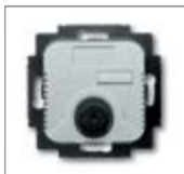
Механизм терморегулятора 1) С дистанционным датчиком и термической обратной связью. для полов с электроподогревом, с контрольной лампой и переключателем для экономичного режима (снижение температуры 4К), Переключающий контакт размыкается по достижении заданной температуры. с крепежными распорками, длина проводки датчика: 4 м, Датчик=NTC, 10 кОм при 25 °С. Диапазон регулировки: +10 - +50 °С. соединительный кабель: 1мм² до 2,5 мм², с отдельным входом для временно-зависимого переключения в экономичный режим, Номинальное напряжение: 230 В~ Номинальный ток: 16 А, при cos φ 1 EN 60730-2-9, EN 60669-2-1
