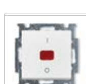
Выключатель с клавишей для 2-полюсных контрольных выключателей с лампой подсветки Номинальное напряжение: 250 В перем. тока Номинальный ток: 20 АХ IEC 60669-1
