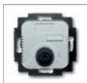
Электронный механизм комнатного терморегулятора 1) 2) 3) с перекидным контактом с крепежными распорками, Номинальное напряжение: 230 В~ Номинальный ток: 5 А Температурный режим применения: 5 °С до 30 °С EN 60730-2-9, EN 60669-2-1
