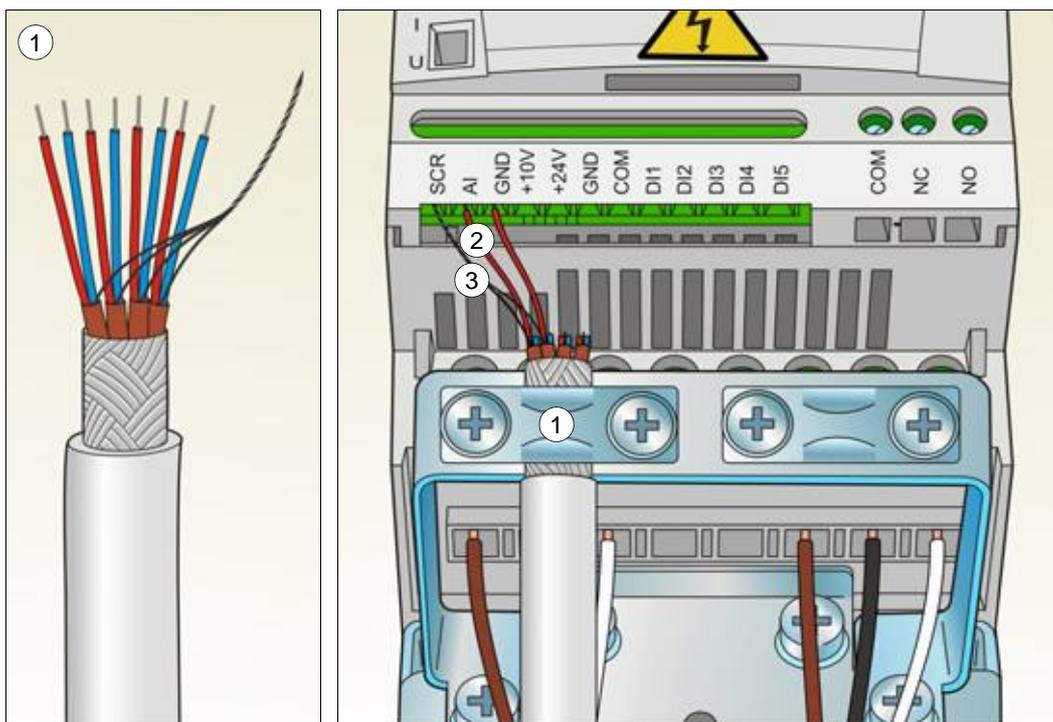
4. *Цифровые сигналы.* Зачистите наружную изоляцию кабеля цифровых сигналов по всей окружности и заземлите оголенный экран с помощью зажима.
