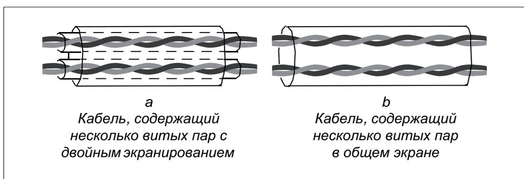
Аналоговые и цифровые сигналы следует подключать разными кабелями.
