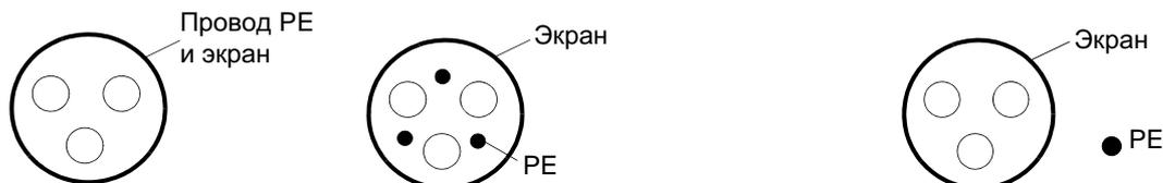
**Примечание.** Необходим отдельный провод защитного заземления (PE), если проводимость экрана кабеля недостаточна для этой цели.
