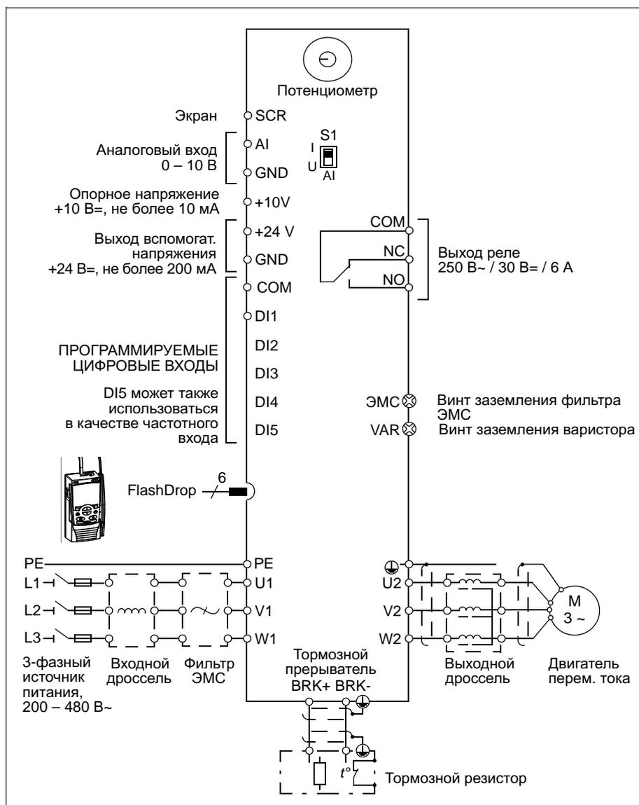
**Примечание.** В случае однофазного источника питания подключите его к клеммам U1/L и V1/N. Относительно подключения силовых кабелей см. *Подключение силовых кабелей* на стр. 41.
