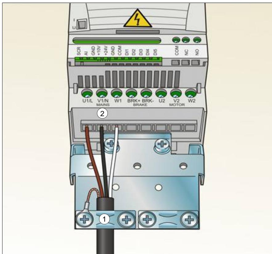
3. Снимите оплетку на кабеле двигателя и скрутите экран, чтобы сделать косичку минимальной длины. Закрепите зачищенный входной кабель питания в зажиме заземления. Обожмите кабельный наконечник на косичке и закрепите наконечник под зажимным винтом заземления.
