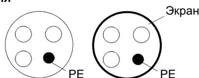
**Не допускается для применения в качестве кабелей двигателя:** для каждой фазы и защитного заземления требуются отдельные кабели
