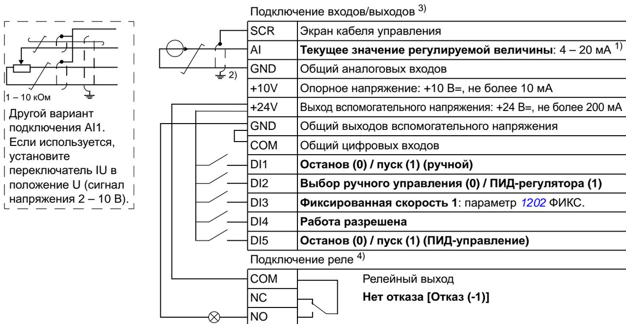
1) Ручное управление: задание частоты поступает с встроенного потенциометра. ПИД-регулятор: задание переменной технологического процесса поступает с встроенного потенциометра.
