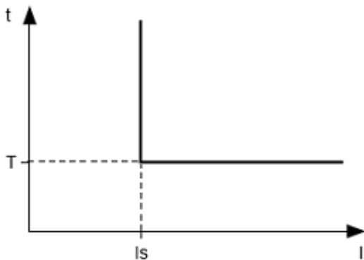
Рисунок 1.4. Принцип защиты с независимой выдержкой времени
