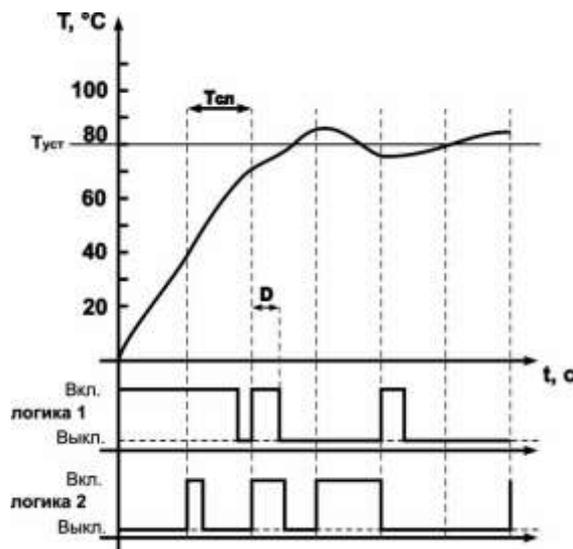
Рисунок 3.11 - Диаграмма срабатывания выходных реле в режиме ПИД-регулирования
