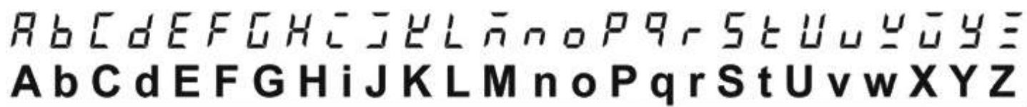
Рисунок 3 - Соответствие начертания символов на цифровом индикаторе буквам латинского алфавита
