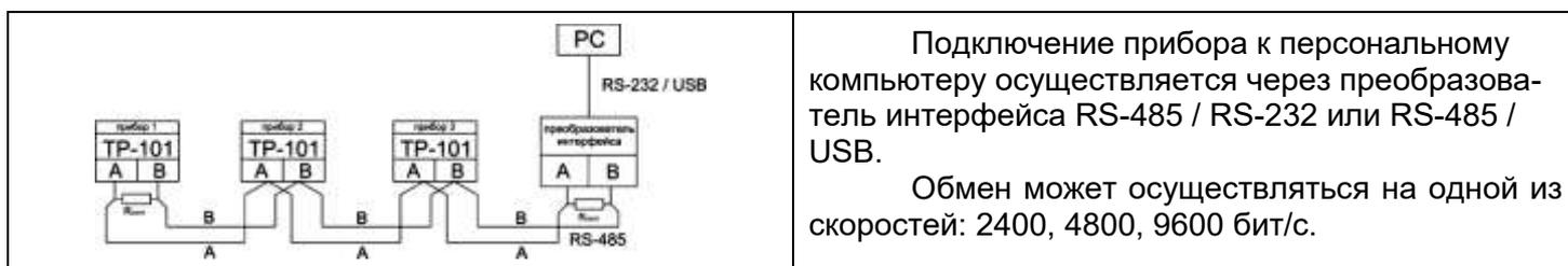
Рисунок А1 - Подключение приборов в сеть RS-485.
