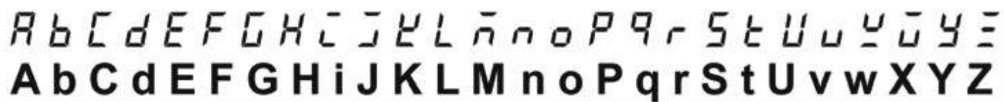
Рисунок 3 - Соответствие начертания символов на цифровом индикаторе буквам латинского алфавита
