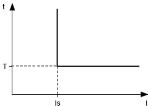
Рисунок 3.1 – Принцип защиты с независимой выдержкой времени
