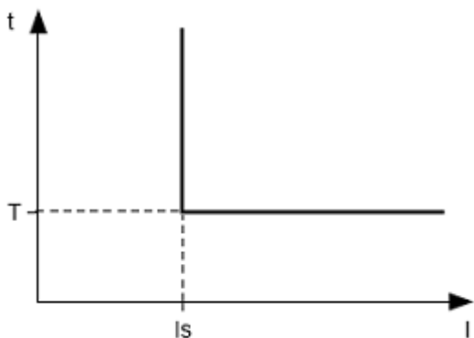
Рисунок 1.2 - Принцип защиты с независимой выдержкой времени
