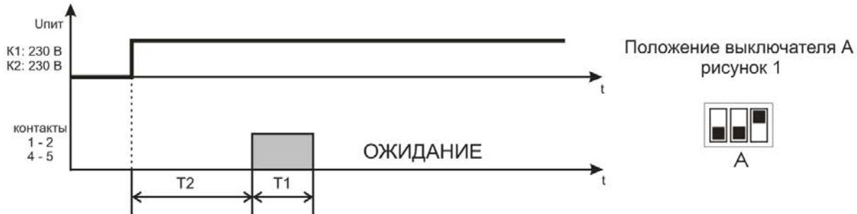
**Рисунок 4 – Алгоритм работы Реле импульсное 1**
