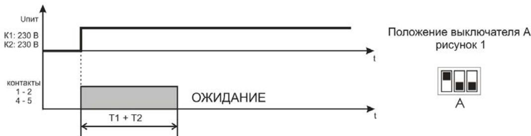
Рисунок 7 – Алгоритм работы Реле импульсное 2
