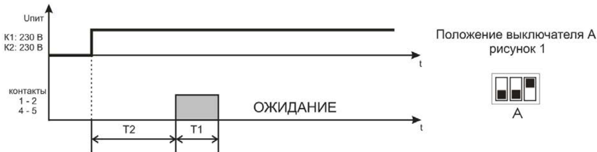
Рисунок 4 – Алгоритм работы Реле импульсное 1
