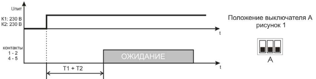
Рисунок 3 – Алгоритм работы Реле с задержкой на включение
