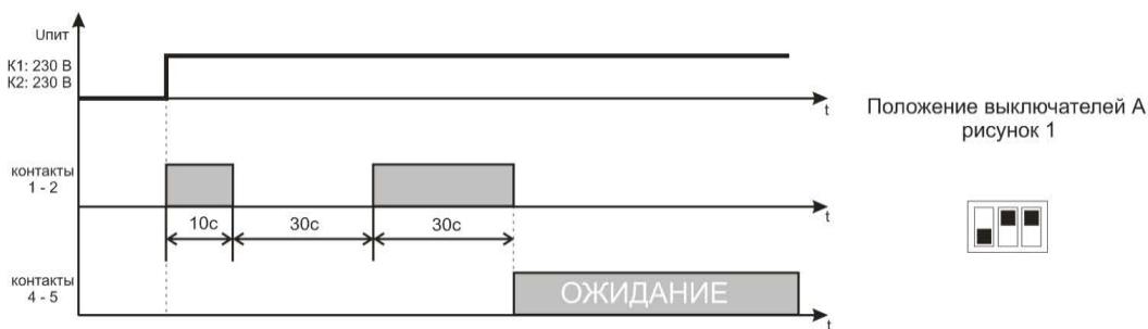
Рисунок 6 – Алгоритм работы Реле управления (предпусковая сигнализация)
