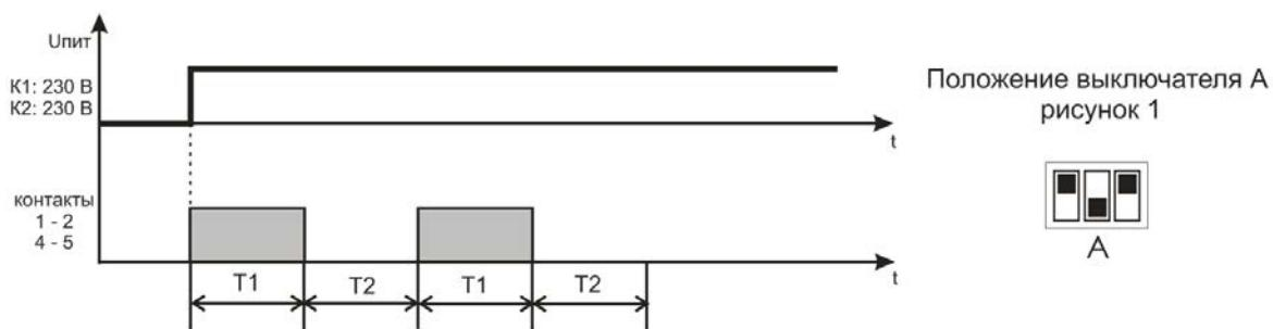
**Рисунок 8 – Алгоритм работы Реле периодическое 2**
