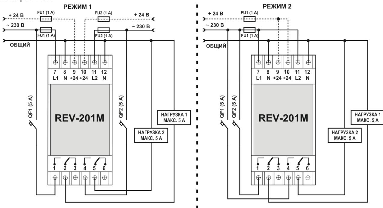
QF1, QF2 – Автоматический выключатель (предохранитель), максимальный ток 5 А.
