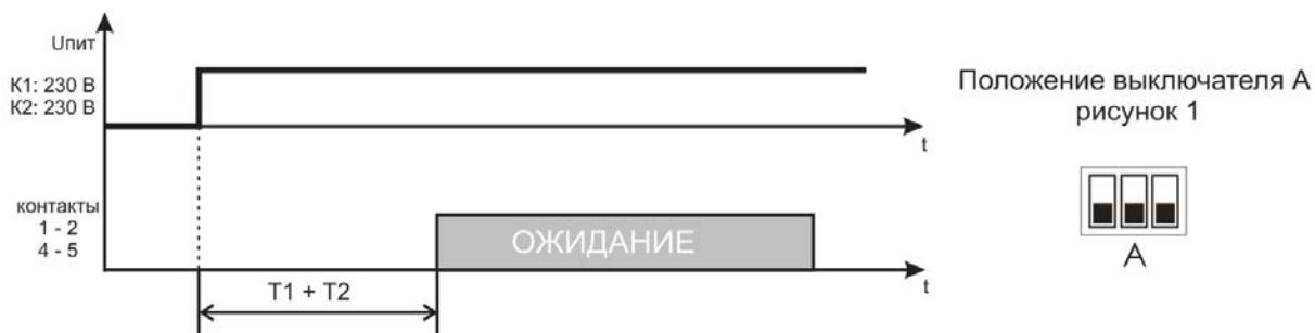
**Рисунок 3 – Алгоритм работы Реле с задержкой на включение**
