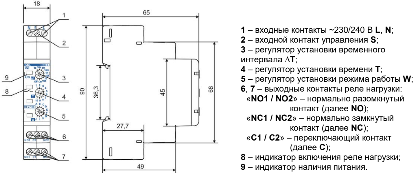
Рисунок 1 – Органы управления, габаритные и установочные размеры РЭВ–120
