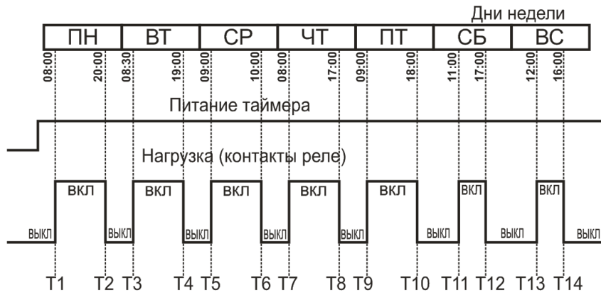
Рисунок 3.4 – Включение нагрузки на примере недельного режима работы
