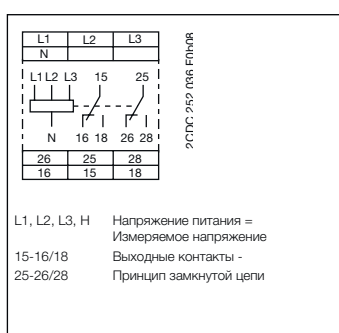
Схема подключения CM-UFS.2
