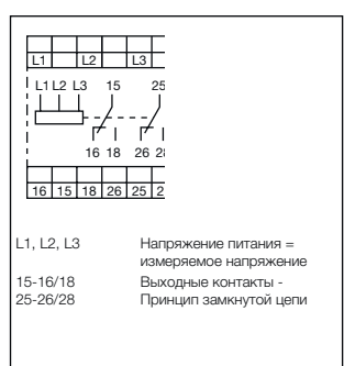
Схема подключения CM-MPN.x2
