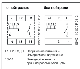
Схема подключения CM-PBE
