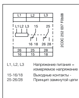
Схема подключения CM-PAS.x1
