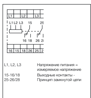
Схема подключения CM-MPN.x2
