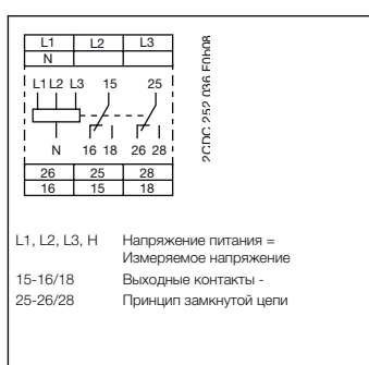
Схема подключения CM-UFS.2
