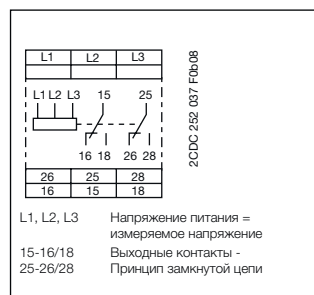
Назначение поворотного переключателя CM-PVS
