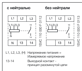
Схема подключения CM-PBE
