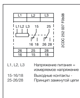
Схема подключения CM-PAS.x1
