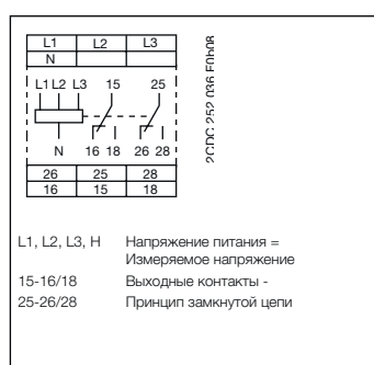
Схема подключения CM-UFS.2
