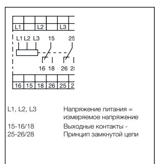
Схема подключения CM-MPN.x2
