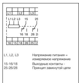
Схема подключения CM-MPN.x2
