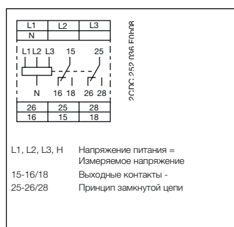
Схема подключения CM-UFS.2
