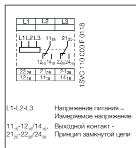
Назначение поворотного переключателя CM-PVS
