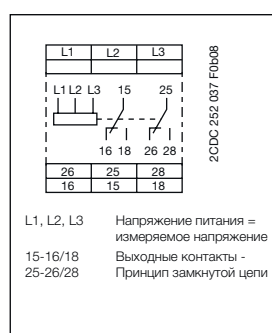
Схема подключения CM-PAS.x1
