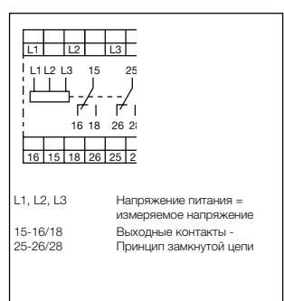
Схема подключения CM-MPN.x2
