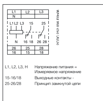
Схема подключения CM-UFS.2
