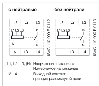
Схема подключения CM-PBE
