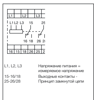
Схема подключения CM-MPN.x2
