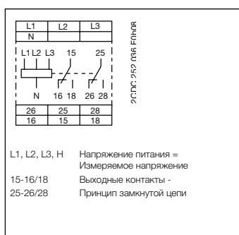
Схема подключения CM-UFS.2
