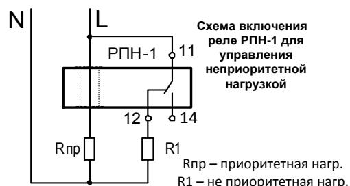
Схема включения реле РПН-1 для управления неприоритетной нагрузкой
