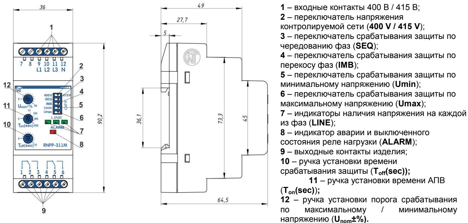
Рисунок 1 – Органы управления, габаритные и установочные размеры RNPP-311M
