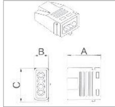
Предназначены для соединения моножильных проводов. Контакт обеспечивается стальной пружиной. Широко используются в цепях освещения.
